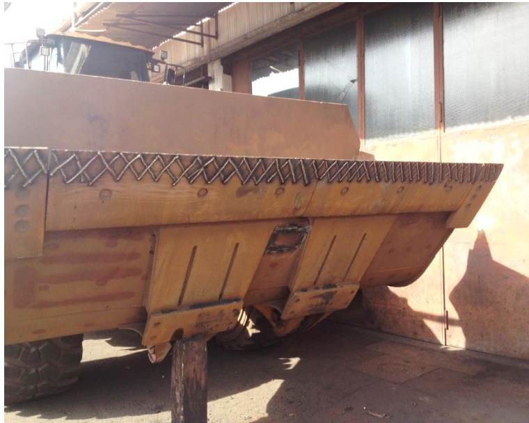
Sanacija noža korpe utovarivača
