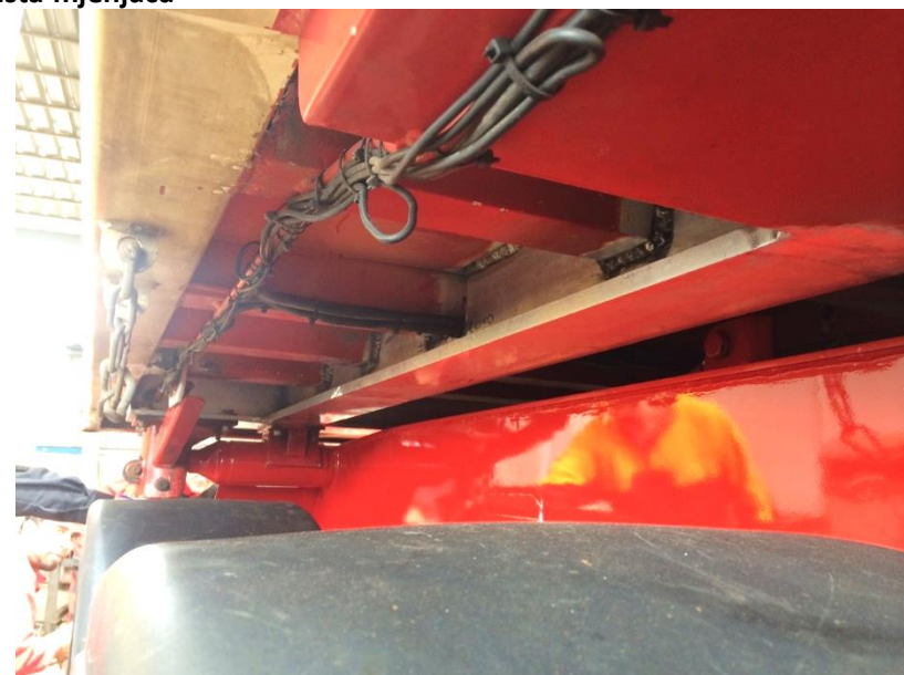
Izmjena i zavarivanje nosive al. grede poluprikolice
