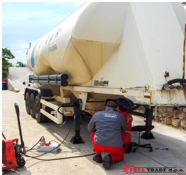
Sanacija pukotine na al. cisterni
