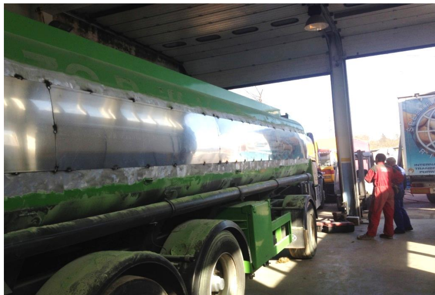
Zavarivanje pojačanja na al. cisterni
