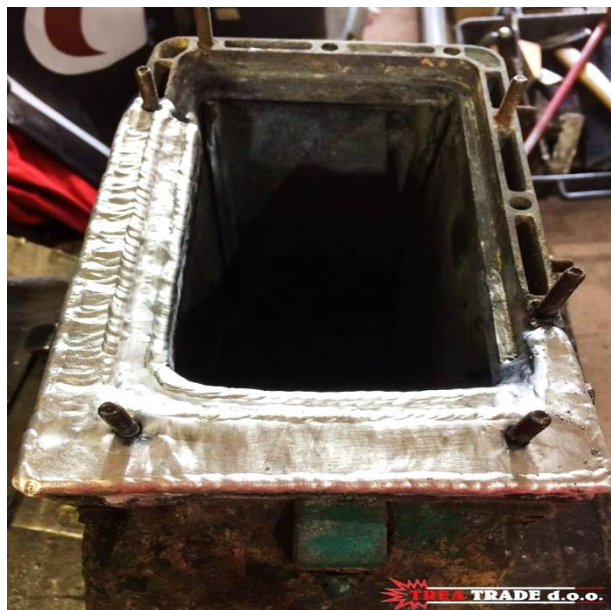
Navarivanje korozijski oštećenog izmjenjivača topline brodskog motora
